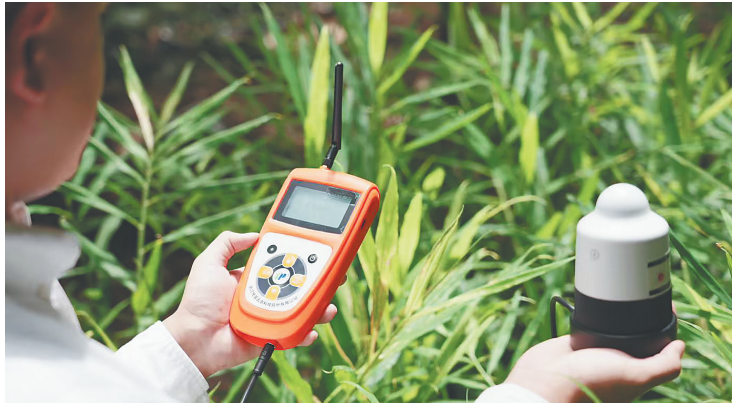
工作人员使用光照度传感器，测量林下光照情况。
