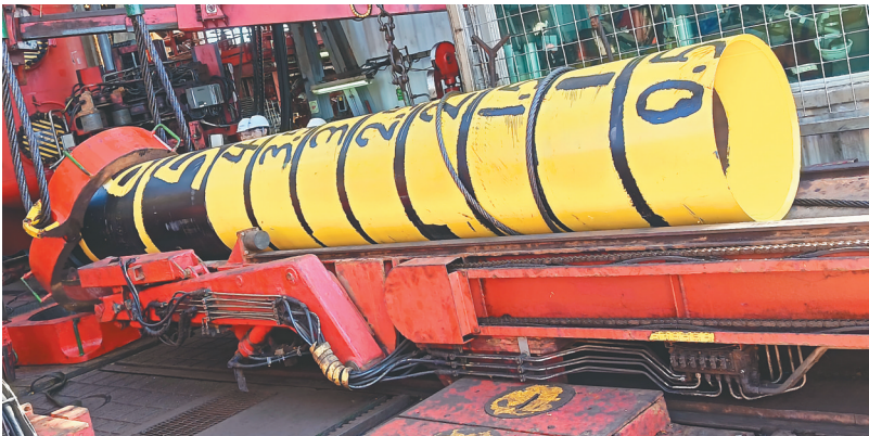
中国海油自研大尺寸深水隔水导管。企业供图
