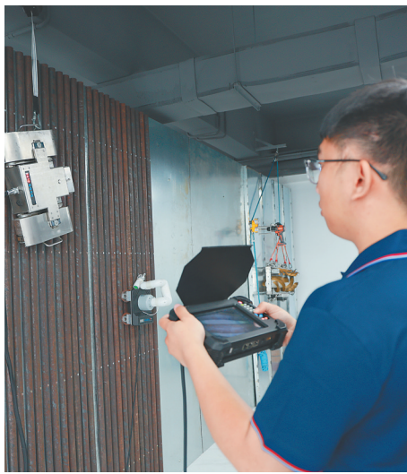
海南南海检验检测有限公司工作人员正在操作一款爬壁机器人。通讯员 秦昌凯 摄
